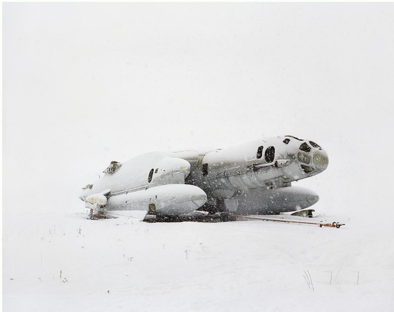
Russia, zona di Mosca, 2013 VVA14, aereo anfibio a decollo verticale; l'URSS costruì solo due prototipi di questo velivolo.
